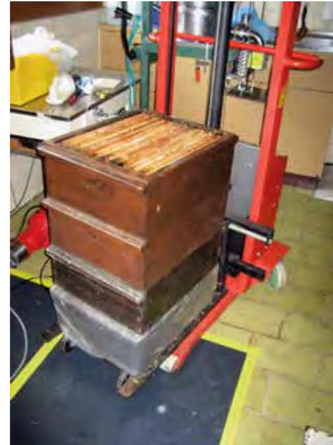
Auf einem selber konstruierten Rollwagen können die Honigmagazine auf Arbeitshöhe gehoben werden.
