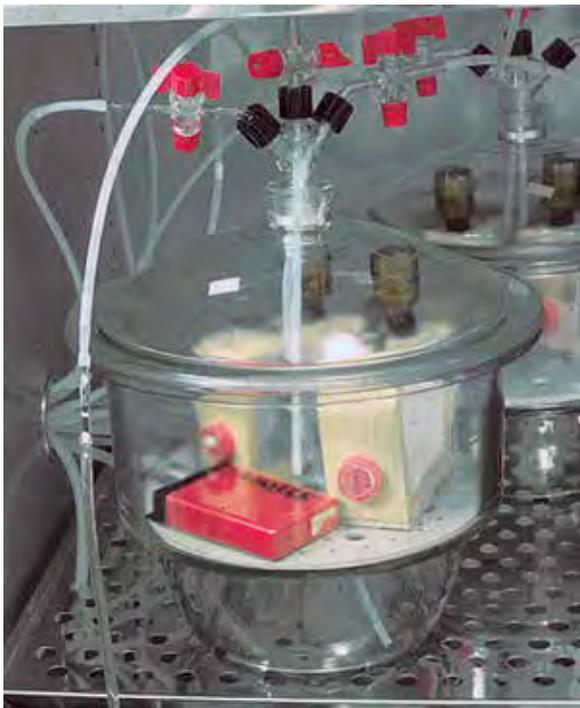
Zwei Liebefelder Käfige mit je ca. 100 Bienen und 20 bis 40 Milben wurden in einem Exsikkator unterschiedlichen Luftkonzentrationen von ätherischen Ölen ausgesetzt.
