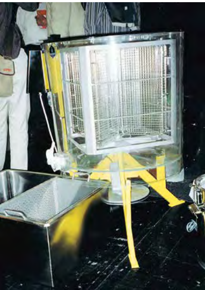
Geeignet zum Schauschleudern, eine durchsichtige Honigschleuder.
