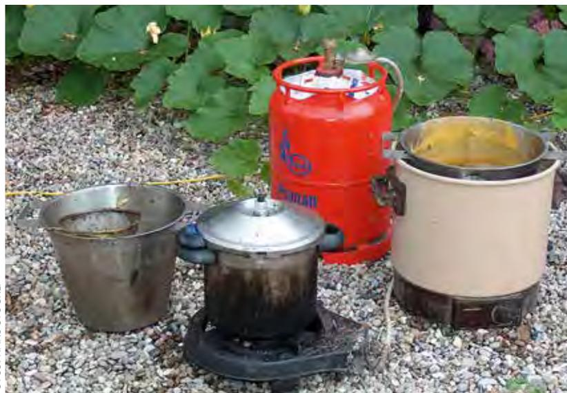
Anlage zur Sterilisation von Bienewachs: Konischer Edelstahl-Wachstopf mit Mehlsieb, Dampf-Kochtopf, Propangasbrenner, elektrischer Kochautomat.
