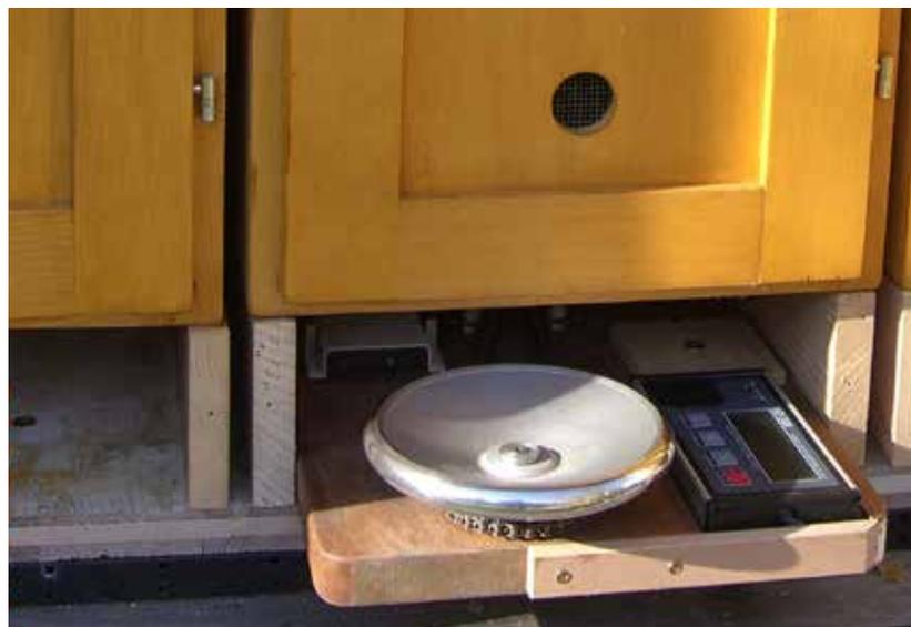
Waage im Einsatz unter einem CH-Kasten mit digitalem Display zum Ablesen der Messergebnisse (links).
