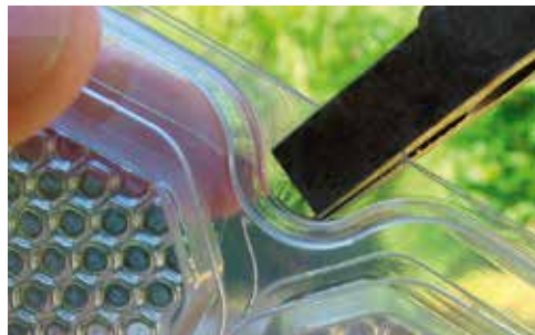
Die beiden Rahmenhälften werden zusammengesteckt und an den Steckpunkten mit der Flachzange zusammengepresst.
