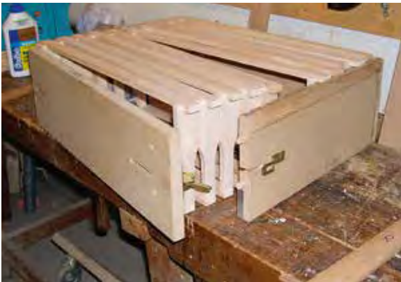
Die fertigen Rahmen können aus der «Lehre» entfernt werden.
