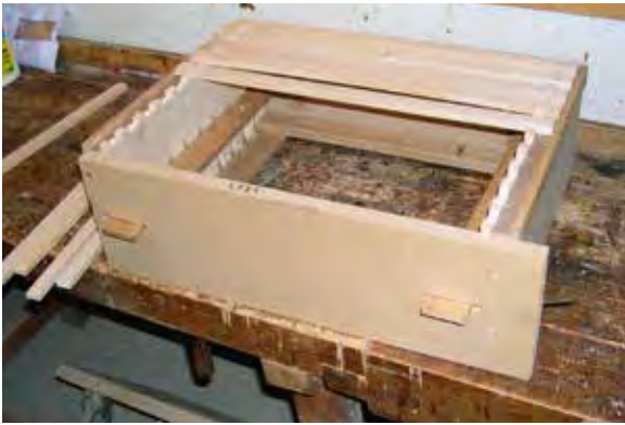
Tragleiste nageln: Eine «Nagellehre» hilft, Fuss- und Trägerleisten präzise anzunageln.
