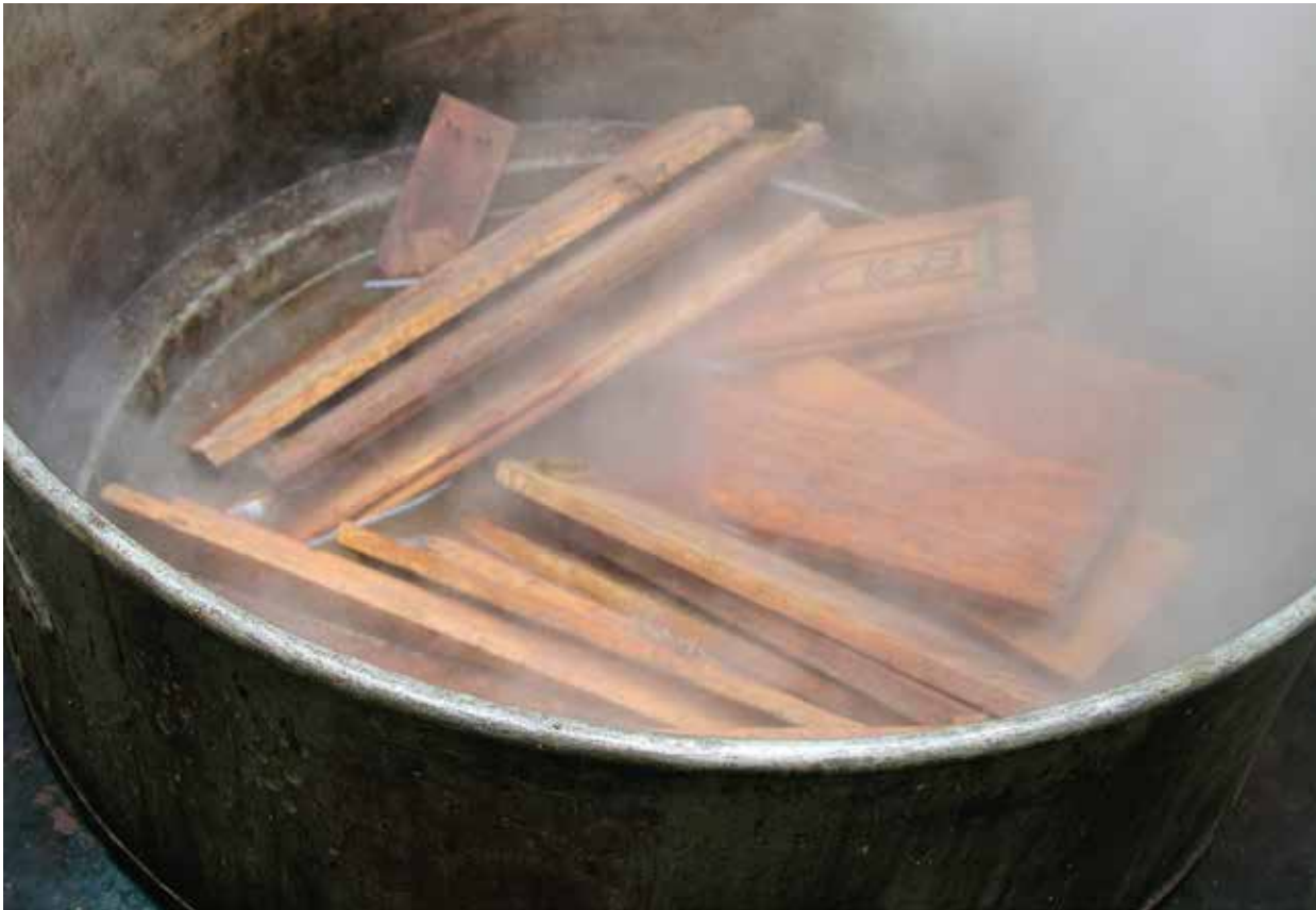
Deckbrettli in der heissen Sodalaug. Anschliessend werden sie gut gespült und getrocknet.
