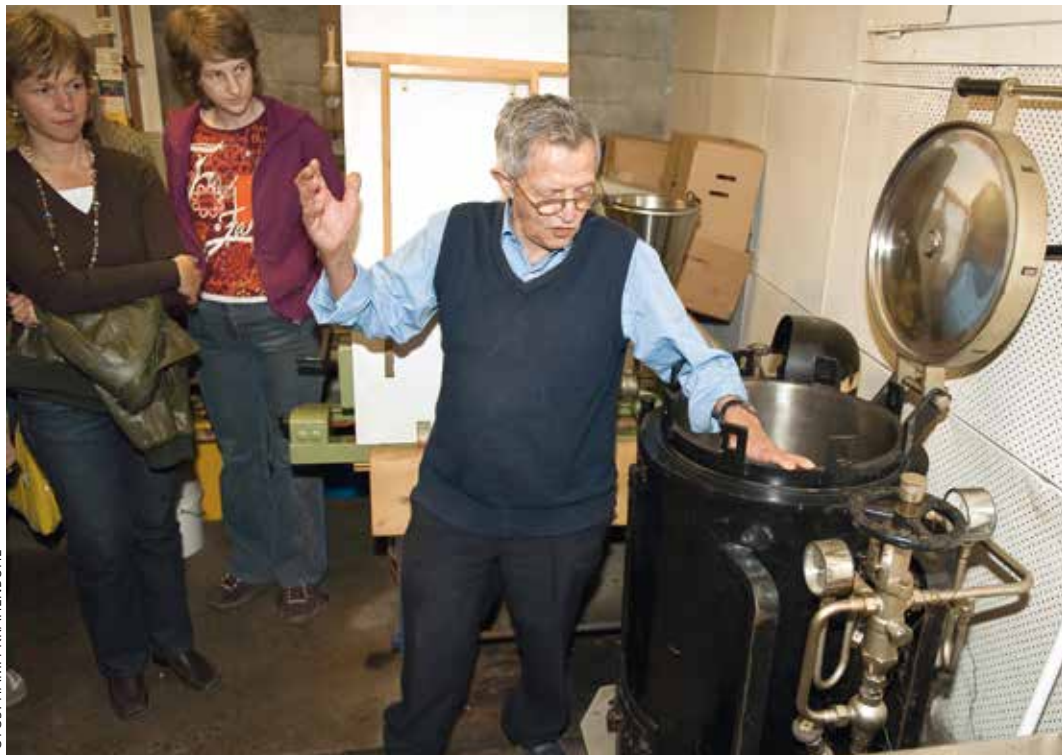
Hans Kurmann erklärt, wie das Wachs bei Temperaturen von 120 °C im Autoklaven entkeimt wird.
