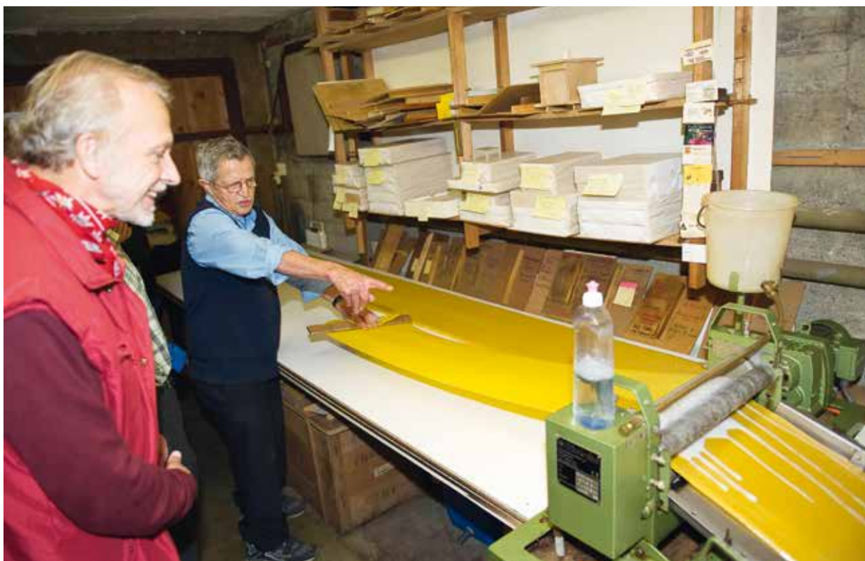
So sieht eine fertig gewalzte Mittelwand aus, wenn Hans Kurmann sie aus dem Walzgerät zieht.
