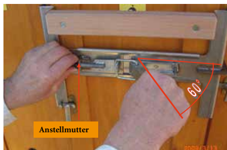
Mit dem BERGER CH-Bienenkastengreifer kann man jeden CH-Bienenkasten an den montierten Griffen sicher packen (links) und bequem zu zweit herumtragen (rechts).
