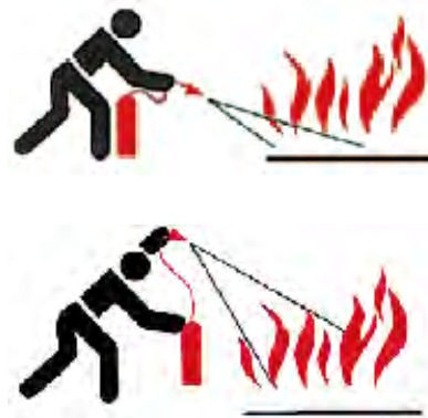
Piktogramme für richtigen Einsatz des Feuerlöschers (oben) und für falschen Einsatz (unten).
