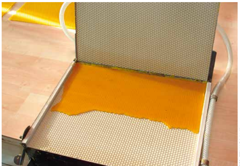
Nicht zu viel Flüssigwachs auf die Mittelwandgiessform giessen.
