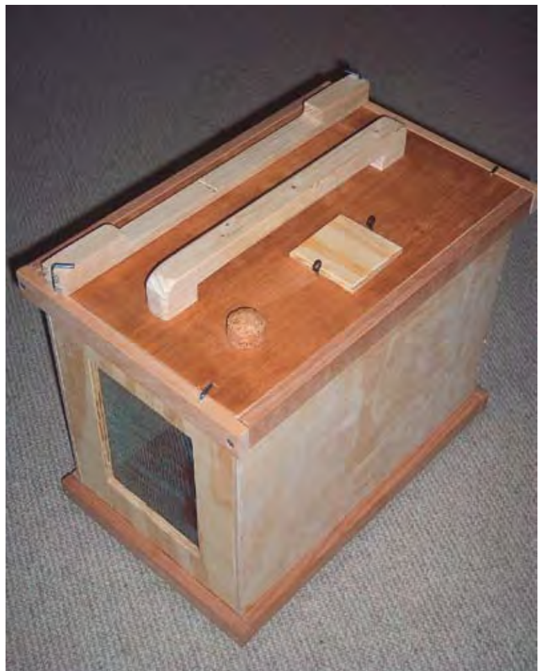
Bild 5: Verschluss, Griff und Deckel für Futterloch montieren. Korken bei Loch für Zusetzer einsetzen.
