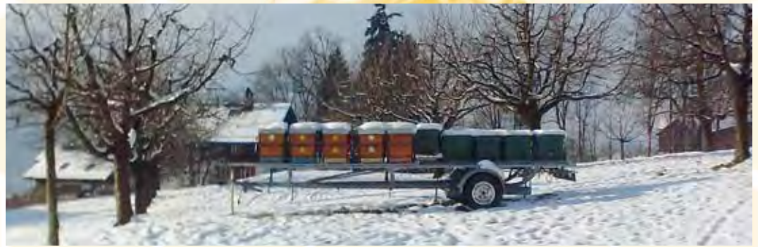
Wanderwagen «Eigenbau». Was früher Segelboote transportierte, dient heute als Magazintransporter. Um die Deichsellast zu verringern, sind die vorderen Holzmagazine nach hinten fahrbar und arretierbar.
