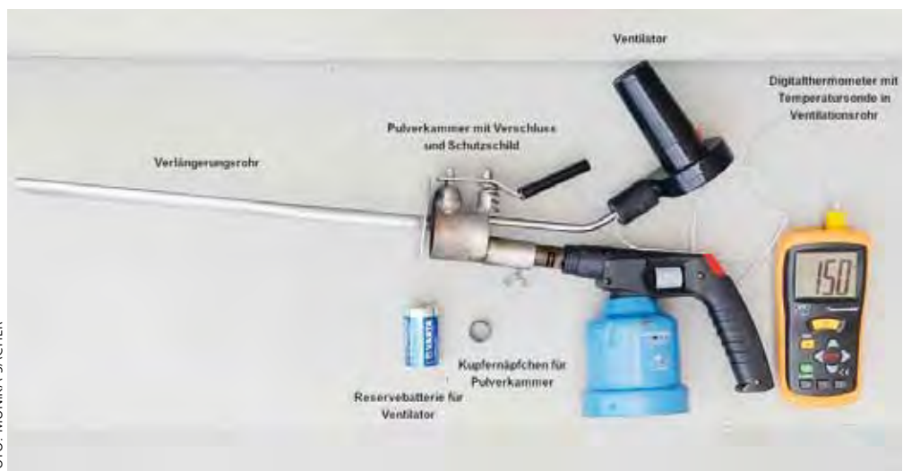
Die einzelnen Bestandteile eines gasbetriebenen Oxalsäureverdampfers.
