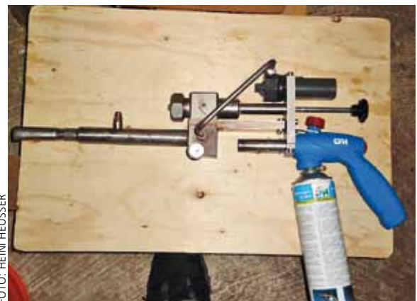
Oxalsäureverdampfer mit doppelwandigem, Wärmeöl gefülltem Verlängerungsrohr.
