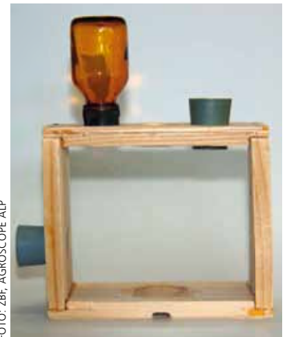
Ein «Liebefelder-Käfig» für Laborversuche mit Bienen.
