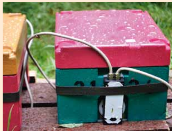
Ein Zuchtkästchen mit einem «elektronischen Flugloch» (oben). Der Transponder misst jedes Mal, wenn eine mit einem Chip versehene Jungkönigin das Flugloch für einen Paarungsflug passiert (rechts).
