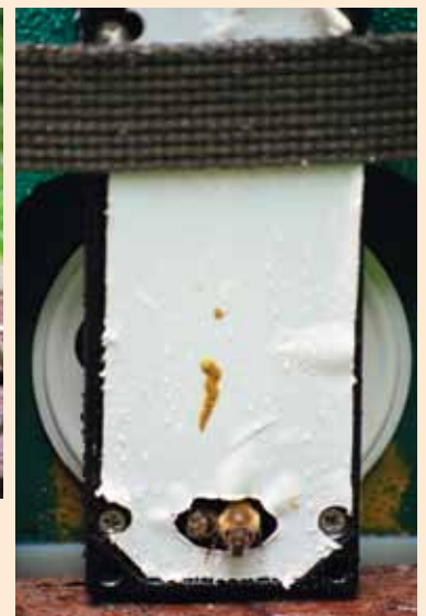
Ein Zuchtkästchen mit einem «elektronischen Flugloch» (oben). Der Transponder misst jedes Mal, wenn eine mit einem Chip versehene Jungkönigin das Flugloch für einen Paarungsflug passiert (rechts).
