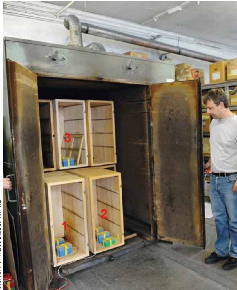
Offener Industrieofen mit den Büchsen (an den Standorten 1, 2 und 3 im Ofen), in welchen sich die infizierten Holzbrettchen und die Temperaturlaufzeichner befanden.
