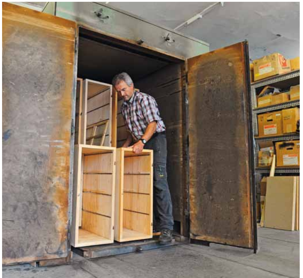
In diesem Industrieofen können gleichzeitig 18 Schweizerkästen desinfiziert werden.
