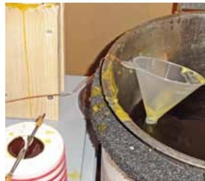
Der Auslauf des Trichters wird bis zum nächsten Giessvorgang im flüssigen Wachs bereitgehalten, damit er nicht durch erstarrendes Wachs verstopft.
