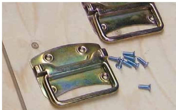
Die Einschlagmutter M5 nach dem Lochbild der Griffe bohren und montieren.
