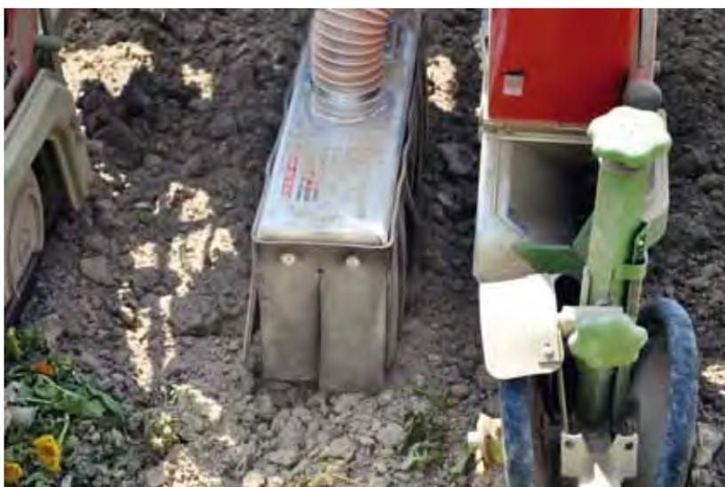
Deflektoren leiten die Abluft der pneumatischen Sämaschinen gegen den Boden, damit darin enthaltener Beizstaub nicht auf benachbarte Felder mit Nektarquellen gelangt.
