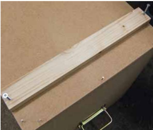
Den Boden beleimen und mit Nägeln fixieren. Bodenleisten mit Holzschrauben 4 x 40 mm verschrauben.
