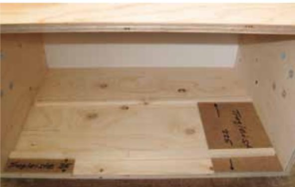
Mit Hilfe von zwei einfachen Anschlägen (Höhe 35 und 225 mm) werden die Waben-tragleisten mit Nägeln an den Seitenwänden befestigt.
