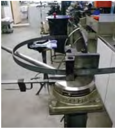
In einer Metallbaufirma wurden zwei Eisenbänder gefertigt, um die Stammhälften wieder zusammenzufügen.
