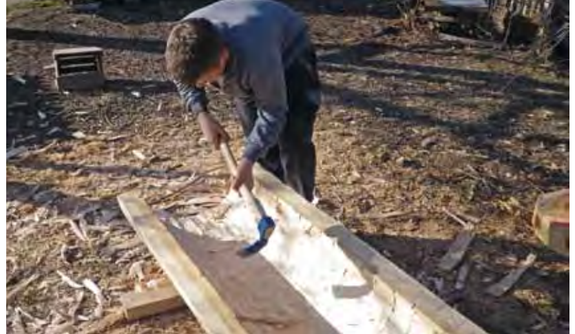
Die Feinaushöhlung ist Handarbeit mit einem Dechsel (Hohlbeil).
