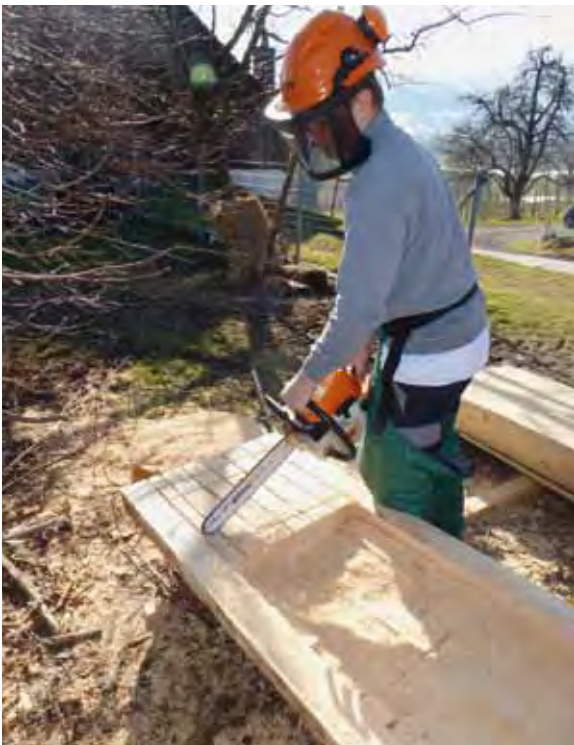
Mit dem Schäleisen wird die Rinde entfernt (oben). Der Stamm wird der Länge nach in zwei Hälften zerlegt (Mitte). Mit der Motorsäge werden die Stammhälften grob ausgehöhlt (unten).
