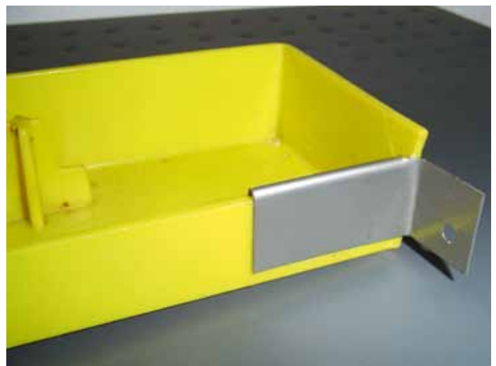
Bild 2: Mit einem Formstück aus Chromnickelstahl lassen sich die defekten Futtergefässe einfach reparieren.
