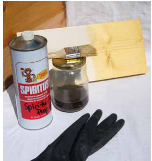
Ein Propolis-Anstrich wird aus Brennspiritus und Rohpropolis hergestellt. Er färbt das Holz honiggelb ein. In mehreren Schichten aufgetragen, entsteht ein dunkleres Ergebnis.
