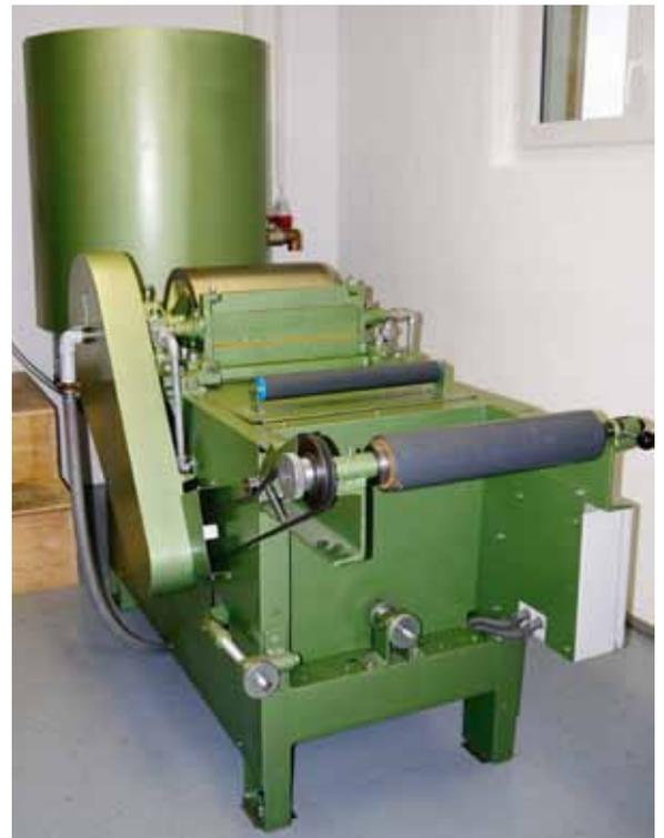
Wachsbandmaschine: Dieser Verarbeitungsschritt führt zu elastischeren Mittelwänden als die Giesstechnik. Es entsteht ein Wachsband ohne Wabenstruktur.
