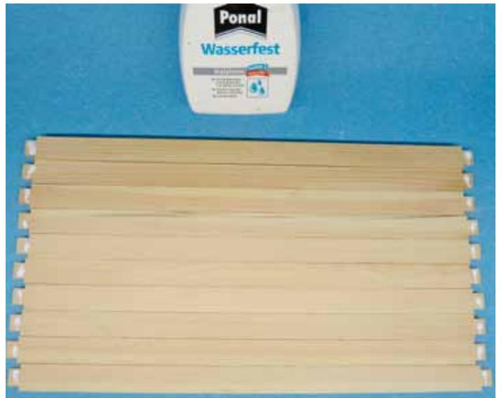
Bild 4: Die unteren Leisten werden mit einem Tröpfchen Leim versehen.
