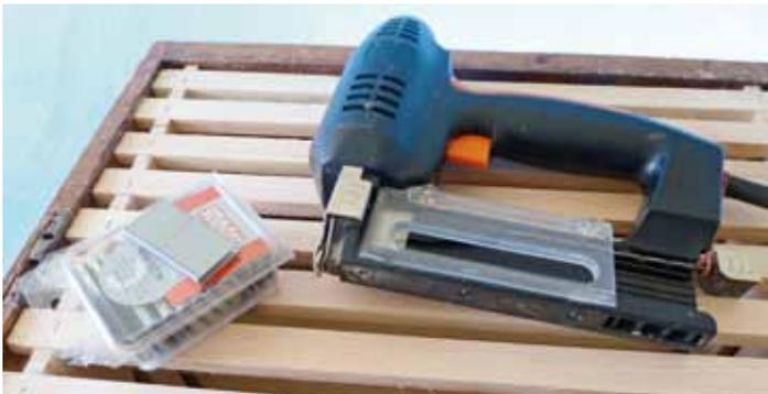
Bild 6: Mit einem Elektrotacker werden die Rähmchen genagelt, zuerst unten, dann oben (Bild 7).
