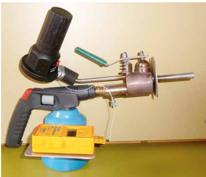
Abbildung 2: Sublimationsgerät mit Gasbrenner, Ventilator und Temperaturmessgerät. Die Temperatursonde liegt im Sublimationsraum, das Kabel wird durch das Ventilationsrohr geführt. Das Messgerät ist mit Klettstreifen auf einer Aluminiumplatte festgemacht, die mit einer Rohrschelle an der Kartuschenhülle festgeklemmt ist. Das Dampfrohr sollte wegen der Desublimation\* möglichst kurz sein.
