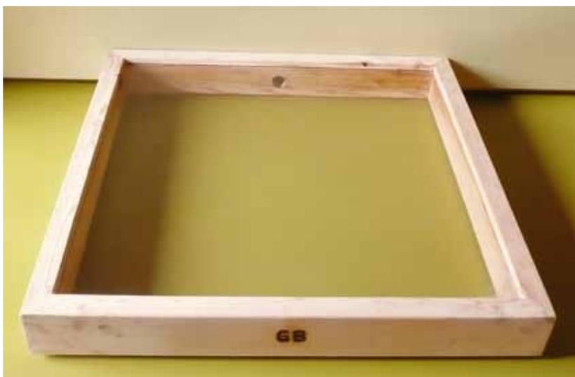
Abbildung 1: Ca. 6 cm hoher Holzrahmen mit Plexiglasdeckel und dem Loch für das Einblasen des «Dampf»-Gasgemisches in der Rückwand.
