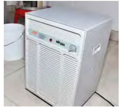
Bild 6: Mit einem Luftentfeuchter kann die Luftfeuchtigkeit im Schleuderraum tief gehalten werden.
