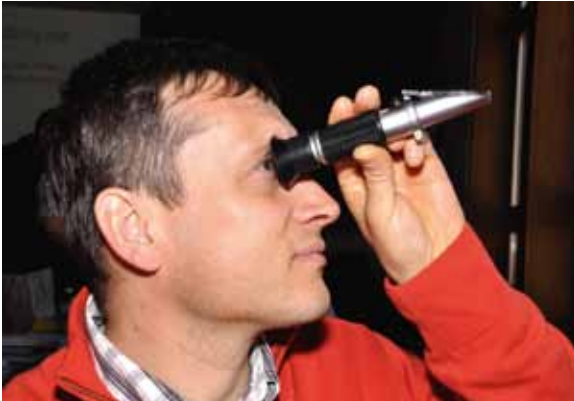
Bild 3: Mit einem Refraktometer kann bei richtiger Anwendung der Wassergehalt genau bestimmt werden.
