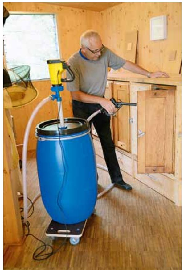
Einfüllen der Futtergeschirre mit aufgesetzter Fasspumpe, Verlängerungsschlauch und Zapfhahn.
