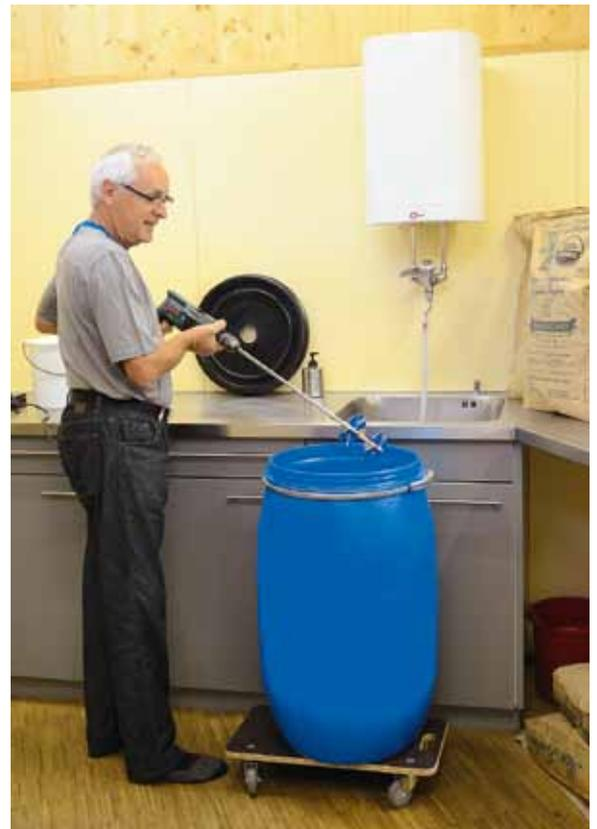
Unmittelbar nach Ansetzen der Lösung und 24 Std. später kurz vor Gebrauch rühren. Achtung: Die Bohrmaschine darf mit der Flüssigkeit nicht in Berührung kommen, da sonst ein gefährlicher Kurzschluss entstehen könnte.
