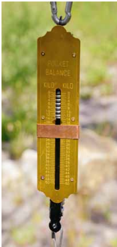
Federwaage mit Kupferplättchen. Die Anzeige der Federwaage verschiebt das Kupferplättchen.
