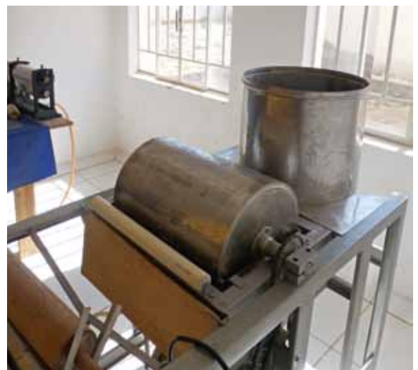
Die Anlage zur Herstellung der Mittelwände.
