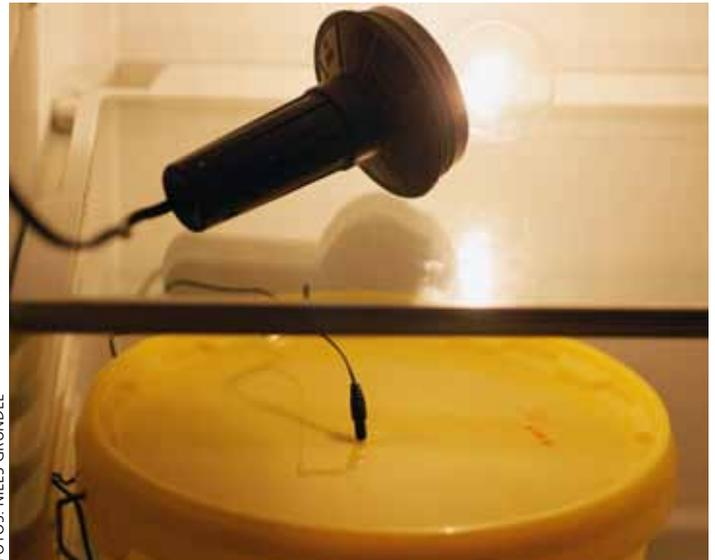
Oben die Wärmequelle, unten der zu verflüssigende Honig und dazwischen der Thermosensor.
