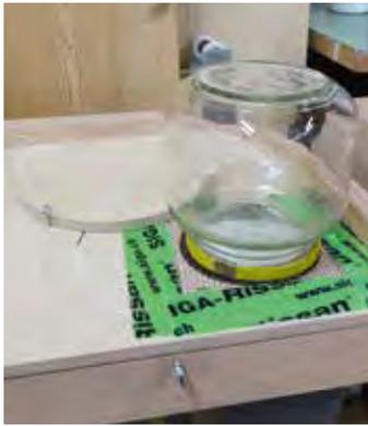
Um das Deckelbrett und den runden Trichterlochdeckel fixieren zu können, braucht es noch drei Ringschrauben, eine für das Deckelbrett und zwei für den runden Deckel. Durch leichtes Drehen der Schrauben können so die Deckel sicher befestigt oder geöffnet werden.
