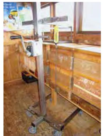
Mit dieser Staplerfunktion der Hebevorrichtung können schwere Beuten leicht angehoben und dank den Rädern problemlos verschoben oder auch auf eine Ladebrücke eines Fahrzeuges verschoben werden (links). Der Futtermittelvorrat eines Volkes lässt sich mithilfe einer Federzugwaage bestimmen (rechts).
