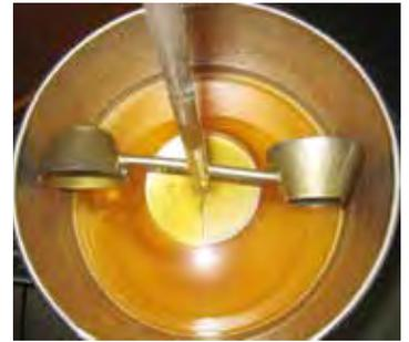
Hub-Schwenk-Vorrichtung zum Heben oder Kippen eines vollen Honigkessels (links und Mitte). In einer Schleuder mit Oberantrieb lässt sich mit einem speziellen Rührstab Honig cremig rühren oder Zucker in Wasser auflösen (im Bild Rührgerät mit Kegelrührarm, rechts).
