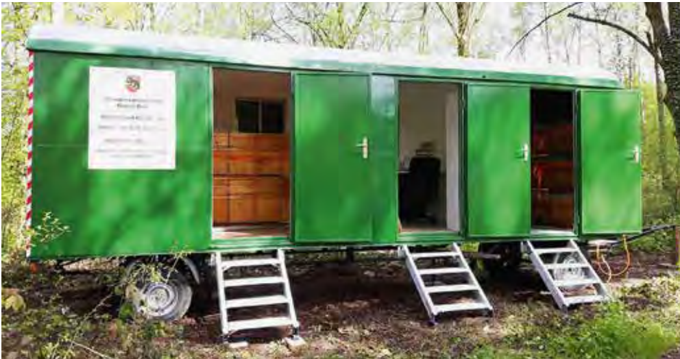
Dieser umgebaute Baustellen-Zweiachser bietet Platz für zwei Materialmagazine und zusätzlich ein Büroabteil.
