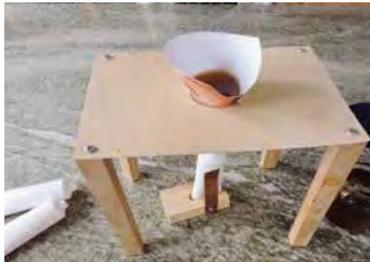
Abfüllvorrichtung (rechts) mit Tubenhalterung (links).
