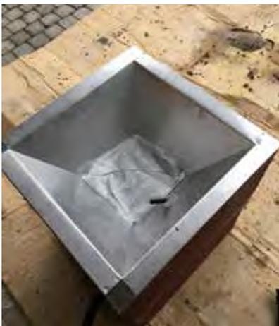
Der rechteckige Chromstahltrichter sorgt dafür, dass die Schmelze in Eimer landet. Der eingelegte Fließfilter klärt das Wachs. Sichtbar ist hier auch der schwarze Dampf-schlauch. Auf den Trichter kommt noch ein Absperrgitter, um den Trester zurückzuhalten.
