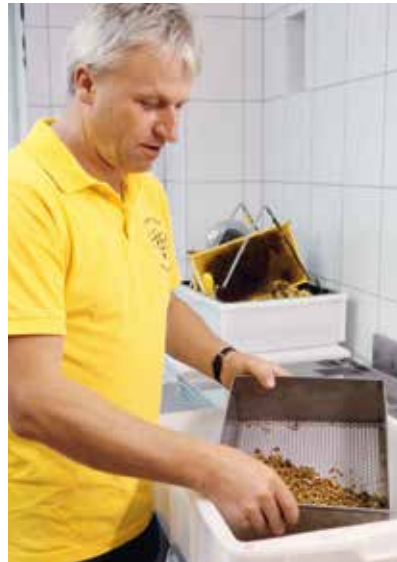
Das zerkleinerte Wabenmaterial wird mit dem mitgelieferten Sieb gereinigt (links). Das bereits sehr saubere Bienenbrot (rechts) wird nochmals im gefrorenen Zustand maschinell bearbeitet, um noch vorhandene Wabenzellen vom Pollen zu entfernen.
