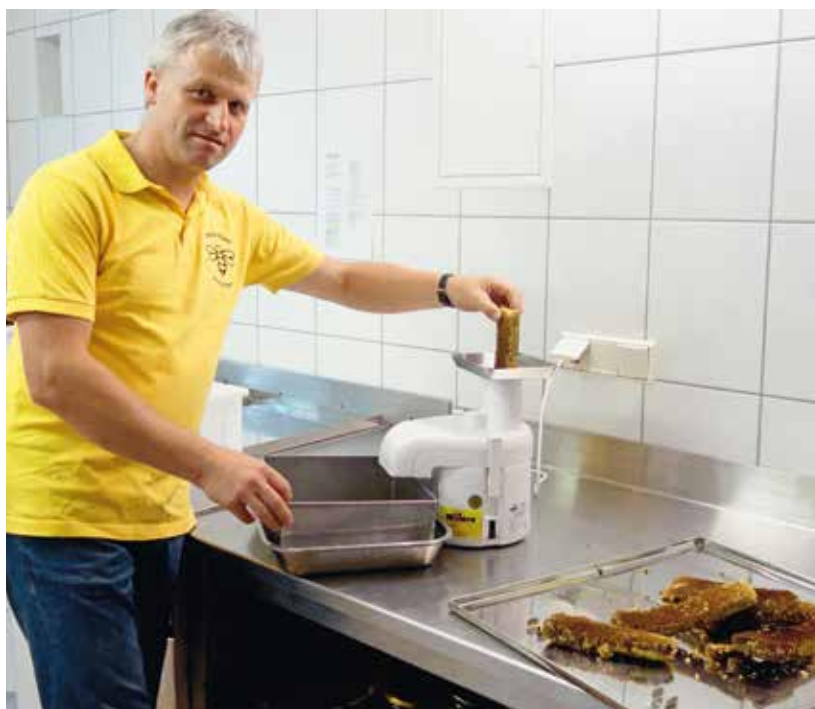
Gefrorene Pollenwabenstücke von 7 cm Breite werden in der Bienenbrot-Erntemaschine zerkleinert.
