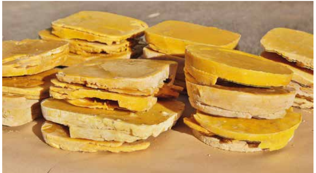
Rohwachskuchen, bereit zur Herstellung von Mittelwänden.
