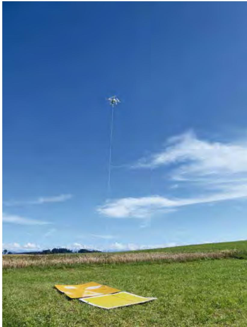
Start- und Landefläche auf einem Acker: Untersicht des fliegenden Phantom 4 mit zentriert befestigter Schleppleine unterhalb des Rotorenabwind-Bereiches.
