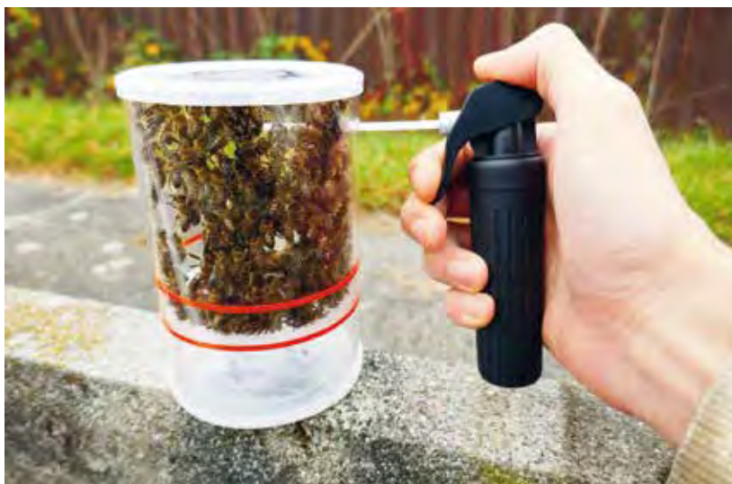
Der Varroatester misst mit der CO 2 -Methode den Varroabefall auf den erwachsenen Bienen.
