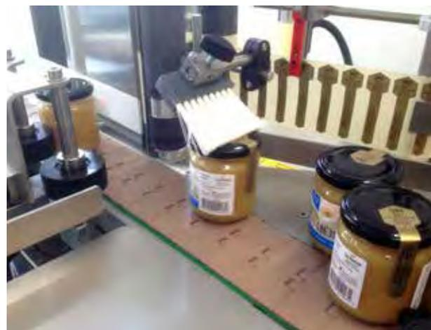
Die Goldsiegel kommen von der Rolle rechts und werden mit dem Schwanz zwischen die freie Fläche des Honigetiketts auf das Glas geklebt. Der Kopf des Siegels steht wenige Sekunden frei im Raum (roter Pfeil), bevor die weisse Bürste ihn auf den Deckel drückt (Foto rechts).
