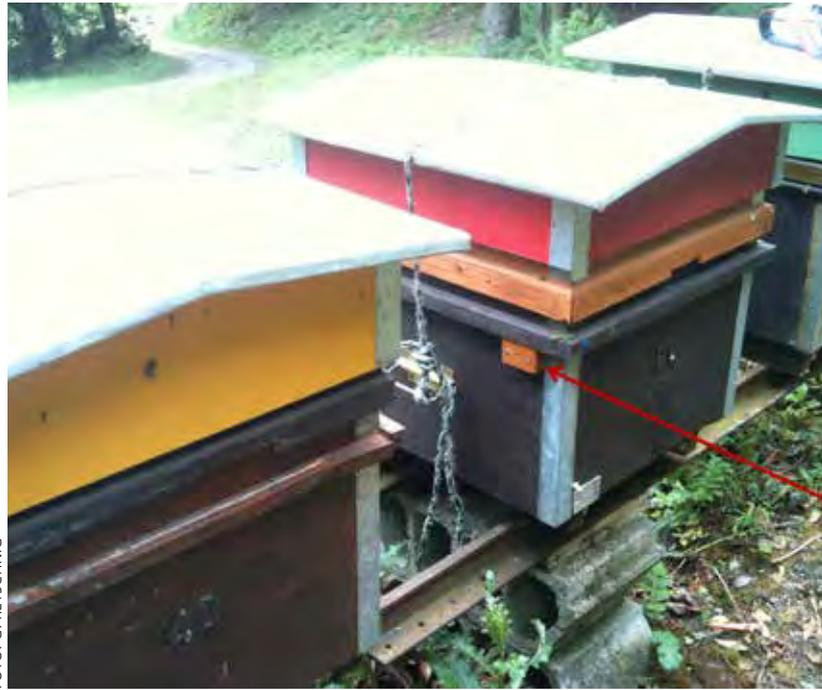
Temperatur-messender Datenlogger in einem hölzernen Schutzgehäuse (roter Pfeil) an einem Bienenvolk.
