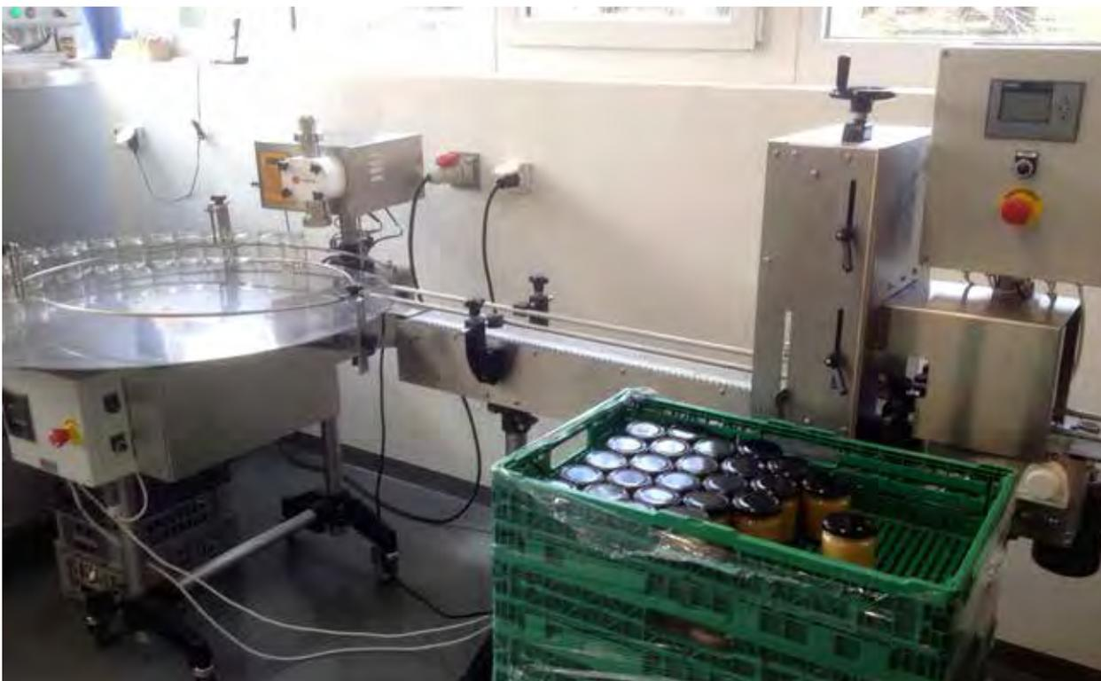
Diese Etikettiermaschine gehört zu einer Produktionsstrasse: Zuerst wird automatisch der Honig in die Gläser abgefüllt, dann der Deckel aufgeschraubt und zum Schluss maschinell etikettiert (von links nach rechts).
