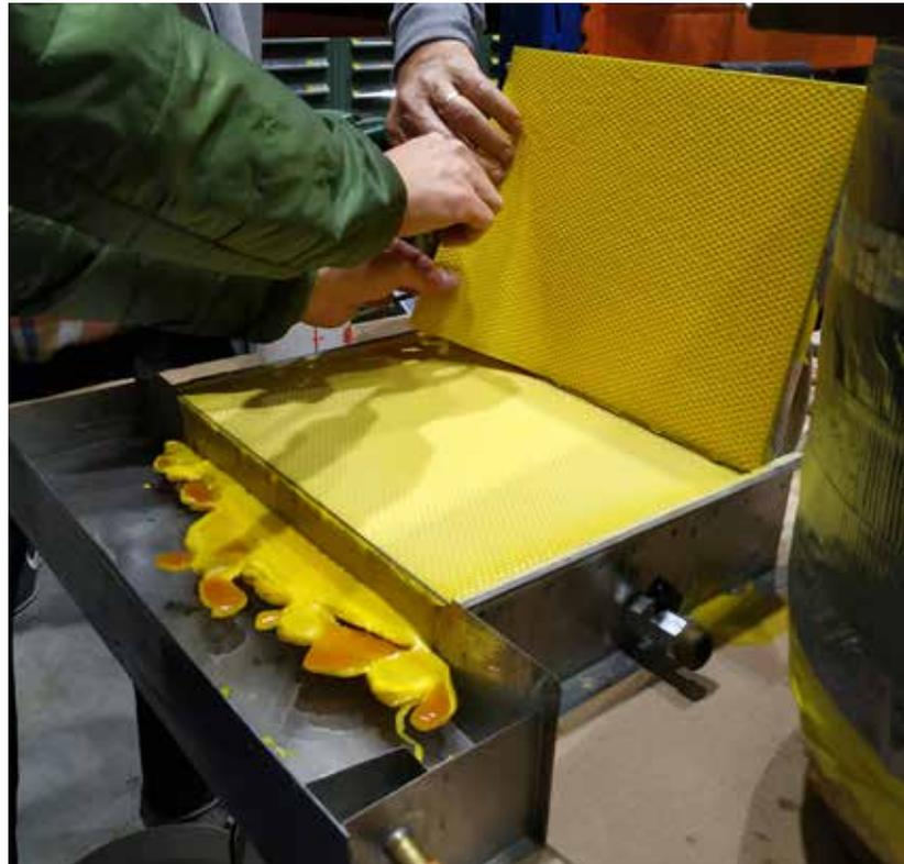
Vorsichtiges Herauslösen der gegossenen Mittelwände.
