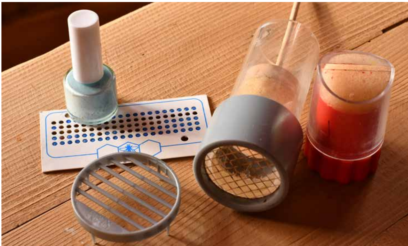
Ausrüstung zum Zeichnen der Königinnen: Aufsteckzeichnungsgitter (vorne links), Zeichnungsrohr (Mitte), Zeichnungskolben (rechts), Opalithplättchen und Zeichnungslack Apicolori blau (hinten links).
