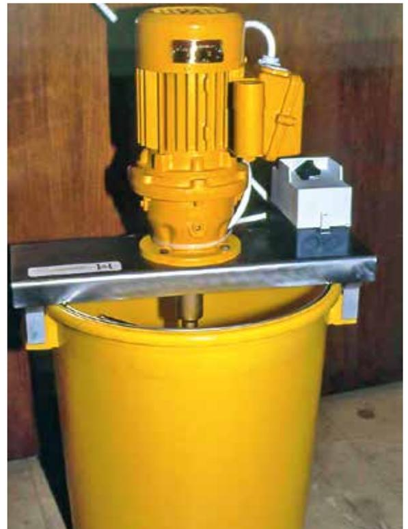
Eine schwere Rührmaschine zur sicheren Befestigung auf einem 40-Kilo-Kessel.
