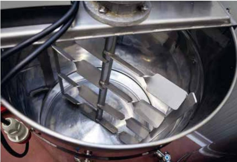
Die stabilen Rührflügel sind durch ihre verschiedenen Anstellwinkel besonders wirksam. Die abgewinkelte seitliche Verbindung wirkt in vertikaler Richtung und kommt besonders nah an die Kesselwand, an der sich die Kristalle gerne ansetzen.
