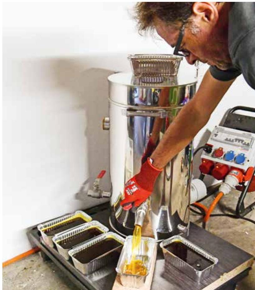
Der Wachsklärbehälter hat in der entsprechenden Höhe einen Hahn zum Ablassen des sauberen Bienenwaxes.
