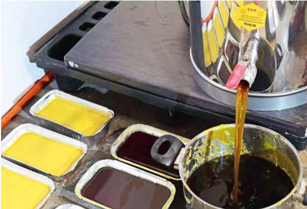
Nach dem Abkühlen erhalten die Wachsblöcke eine schöne gelbe Farbe. An der tiefsten Stelle des Wachsbehälters befindet sich der separate Ablass für die Schmutzablagerungen. Dieses verunreinigte Wachs wird in einer Fünf-Liter-Pfanne gesammelt und beim nächsten Klärgang wiederverwendet.
