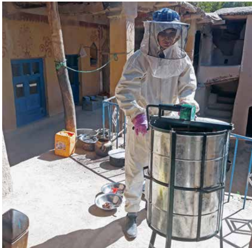
Mit einer lokal angefertigten Honigschleuder gewinnen die Imkerinnen den Honig für den Verkauf.
