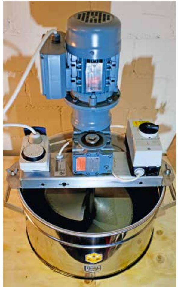
Unser Honigrührgerät kann bis 100 kg Honig schonend und praktisch ohne Lufteinschluss cremig rühren oder gründlich mischen. Eine einfache Holzkonstruktion um die unteren zwei Drittel des Bottichs ermöglichen eine schonende Erwärmung des Honigs mittels Umluftheizung und zusätzlichen Thermostats.
