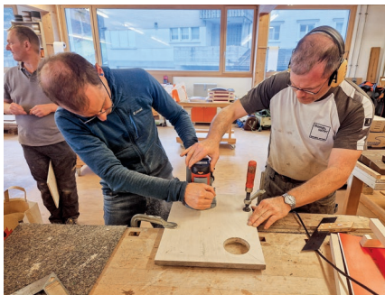
Oben: Zum Bau der Feglingskästen dient ein gut eingerichteter Arbeitsplatz. Unten links: Löcher fräsen und rechts Trichter fixieren.
