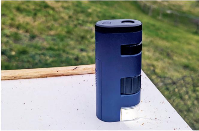
Handmikroskop mit 20 bis 60-facher Vergrößerung.
