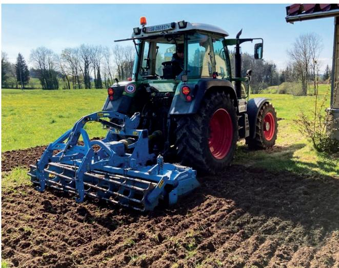
Mit dem Schälpflug und der Kreiselegge wurde der Boden für die Blumenwiese bearbeitet.
