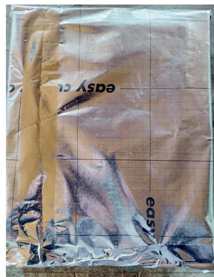
Mein Thermoschield besteht aus einer Bannwabe gefüllt mit Isolationsmaterial. Anschliessend wird das Thermoschield mit einer Folie, welche im Baumarkt als Bodenfolie unter Parkettböden verkauft wird, umhüllt. Ein Thermoschield kann aber auch aus einem Wabenrahmen, der mit Sagex, Schafwolle oder ähnlichem Material gefüllt und zum Beispiel mit Papatex geschlossen ist, gemacht werden.
