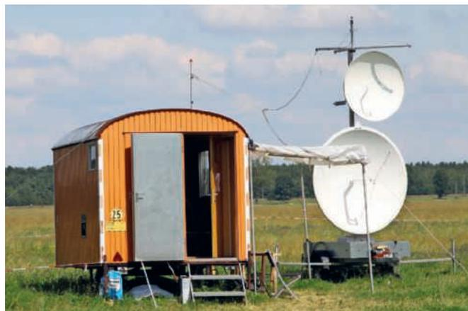
Das harmonische Radargerät zur Aufzeichnung von Bienenflügen: Die untere Antenne sendet den Radarstrahl (8 GHz) aus und die obere Antenne empfängt das harmonische Signal (16 GHz) des Transponders auf dem Rücken der Biene.
